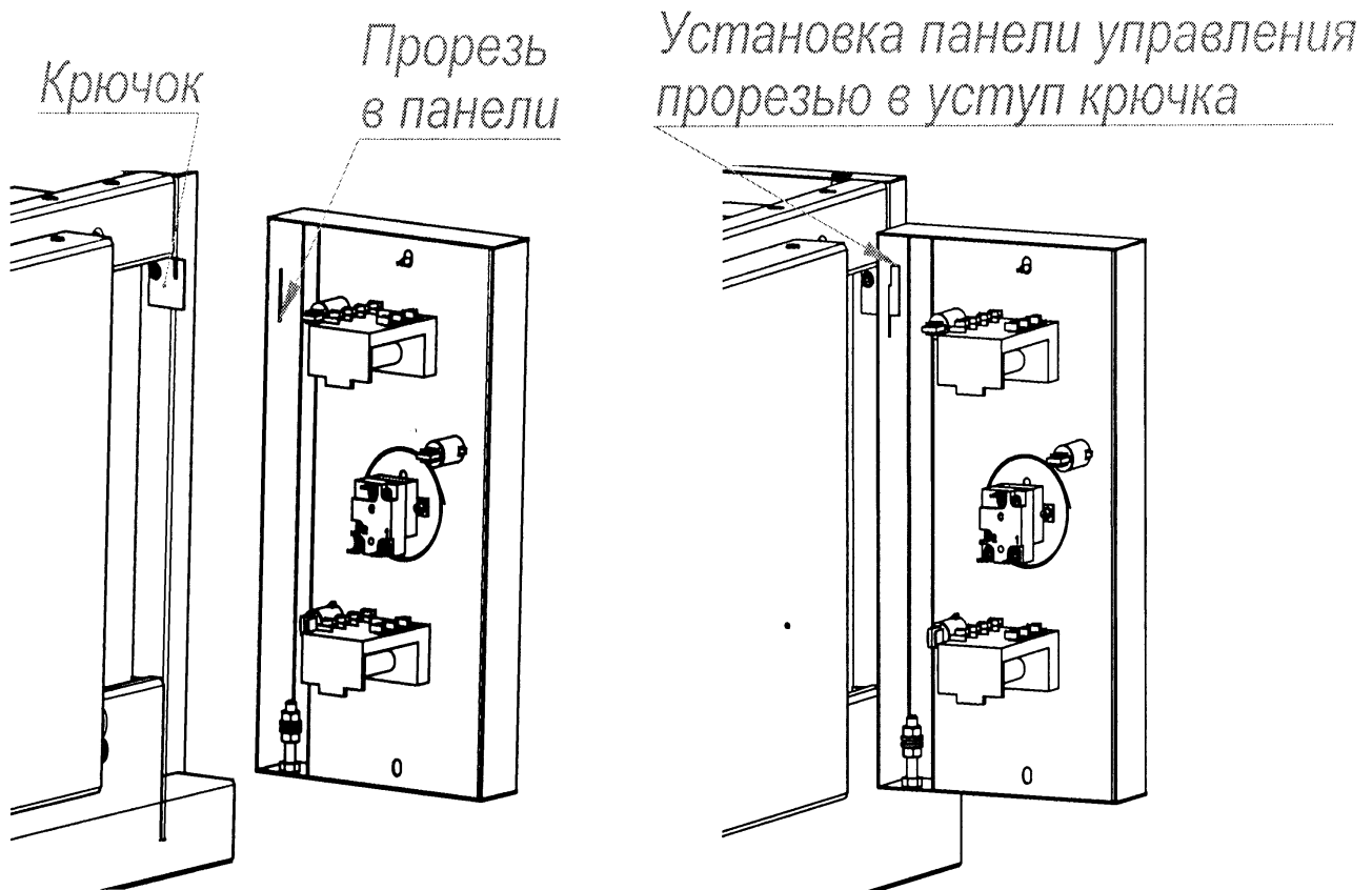
Рис. 5. Технологическое окно для замены контрпетли.
