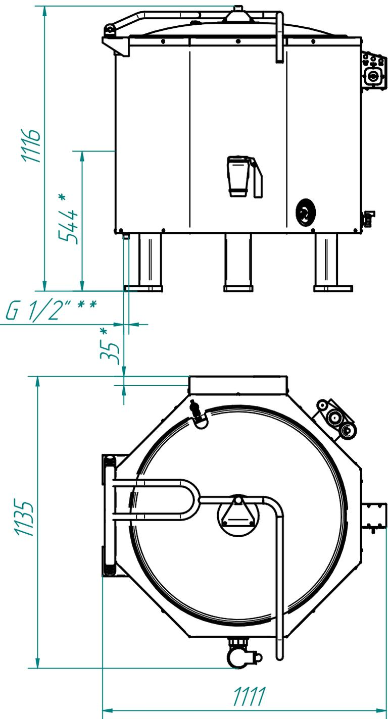
Котел пищеварочный электрический типа КПЭМ предназначен для приготовления бульонов, третьих блюд, кипячения воды. Имеет три режима работы. Слив готового продукта осуществляется краном 2" на лицевой панели. Удобная ручка крышки фиксируется в любом положении. Нагрев воды осуществляется способом "пароводяной рубашки". При отсутствии воды в "пароводяной рубашке" срабатывает автоматическое отключение котлов. Котел поставляется с монтажными лапами, крепящимися к полу фундаментными болтами М10х100.
