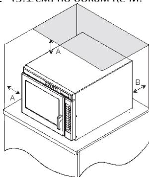
**Расстояния при установке печи****Установка печей друг на друга**
